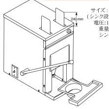
サイズ: W500mm×D670mm×H1,625mm (シンク設置時、上部突起部 240mmを含む) 電圧:100V 50Hz/60Hz 消費電力0.75kw 重量:57.8kg(50Hz) 55.4kg(60Hz) シンク 26.3kg
